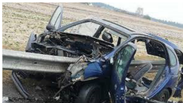
Рисунок 1 - Характер повреждения профильных ограждений автомобильных дорог.
